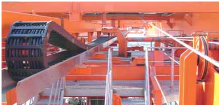
Langer Verfahrweg mit einer energieeffizienten E4/4 rol e-chain® - spart Antriebsleistung
