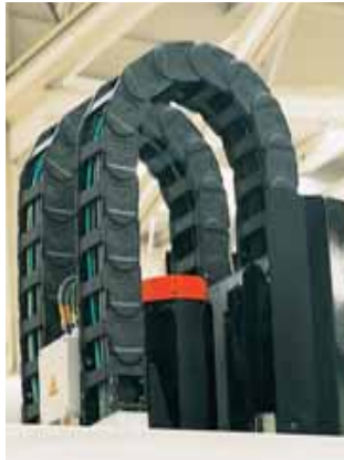
Starre KMA Anschlusselemente - Stirnseitige Montage
