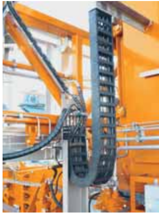
Stehende Anwendung - bis zu 100 m Höhe sind möglich mit e-ketten®
