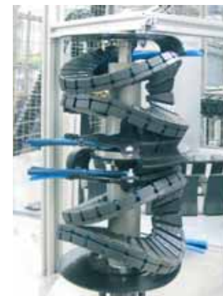
twisterband-Anwendung von zwei übereinander montierten Systemen
