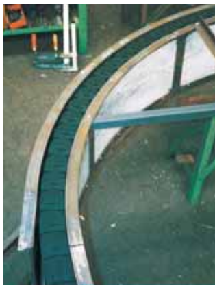
Führungsrinnen System RM für Kreisbewegungen mit RBR
