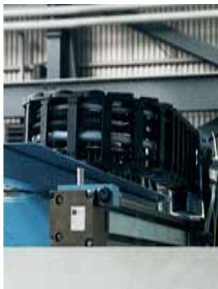
Liegende e-kette®, eine Seite der e-kette® ist unterstützt
