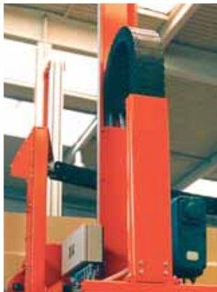
U-förmig unterstütztes e-rohr bei hoher Querbeschleunigung
