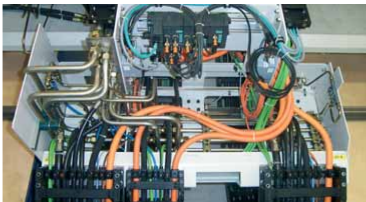
igus® chainfix Zugentlastung im KMA in der Praxis - hier genutzt für Kabel und Schläuche
