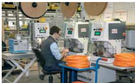
Drallfreies Leitungshandling und vollautomatische Crimpautomaten
