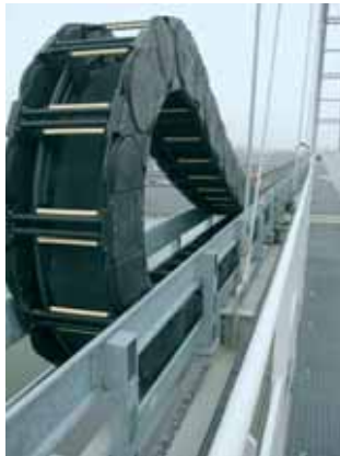
Langer Verfahrweg mit der größten e-kette® der Welt - Serie E4.350
