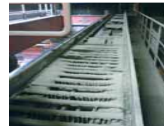
System E4 in einer Müllverbrennungsanlage mit sehr abrasiver Staubbelaftung
