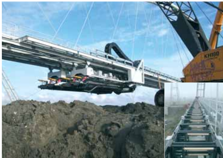
Weltweit größte Polymer e-kette®: Leichter als vergleichbare Stahlketten bewegt sie mühelos mehr als 100 kg Füllgewicht pro Meter auf 138 m Verfahrweg
