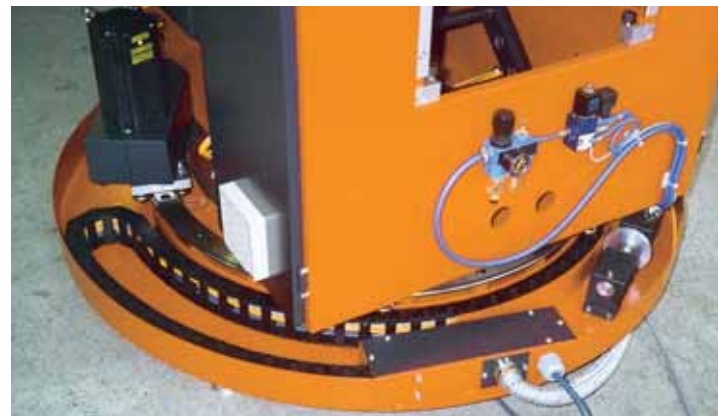
System E2 mit RBR für 360° Kreisbewegung an einem Roboter
