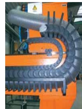
Eine E4 Bügelkette mit Absaugschlauch führt hier zusätzlich eine E2 e-kette®
