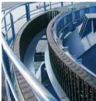
RBR-Kreisbewegung mit dem System E4 an einem Hafenkran
