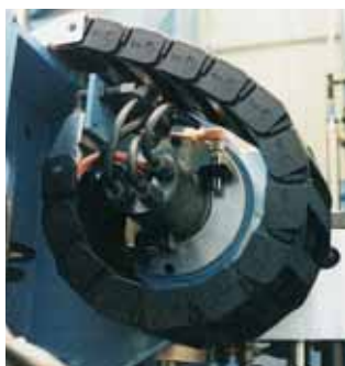
Drehbewegung auf einer igus® Standard e-kette®
