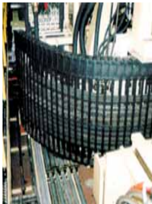
Hydraulik und Elektrik werden in diesem Beispiel von einander getrennt
