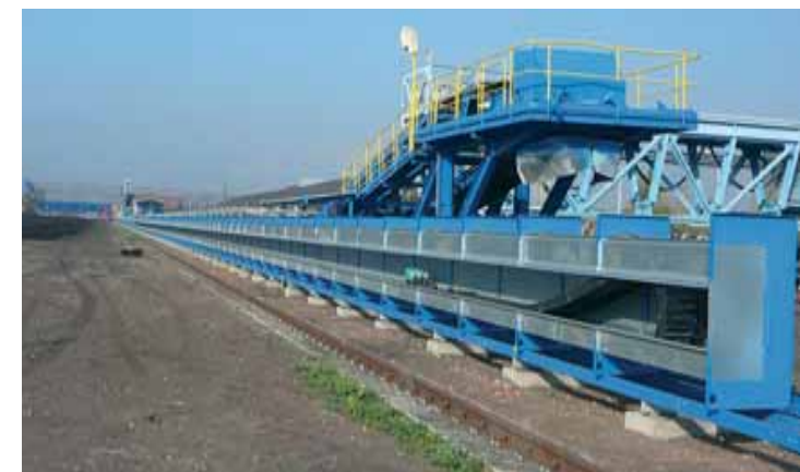
Der weltweit längste igus®-Verfahrweg von 615 m mit e-ketten® und chainflex®-Leitungen
