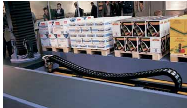
Beispiel für freitragend mit Bogen FL_B
