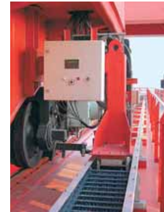
Elektronischer Schub-/ Zugkraftüberwachung mit dem igus® PPDS-System
