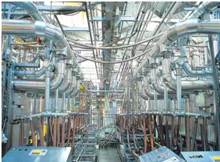
igus® Fabrik: Automatische Compoundier- und Fördereinrichtung für igumid G / GLW
