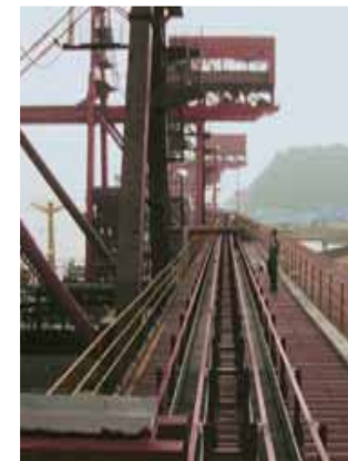
Hohe Brandschutzvorschriften - rol e-chain® Serie 4040R an einer Entlastestation für Kohle, 190 m Verfahrweg, 8 kg/m, v = 0,5 m/s
