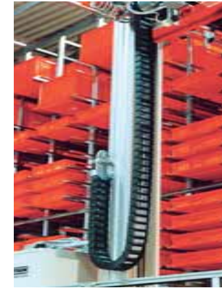
Das System E4.1 ist eine der besten Lösungen für hängende Anwendungen
