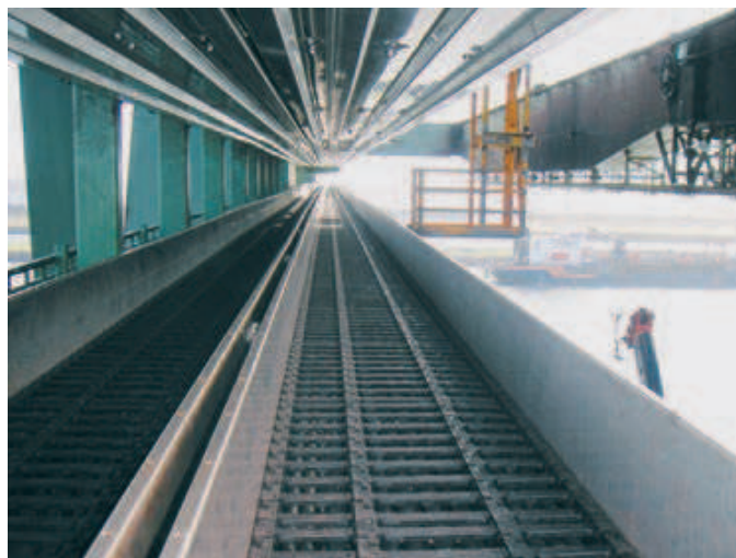
igus® System E4 mit Mittellasche an einem Schiffsentlader für die Kohleentladung. Verfahrweg 105 m, Geschwindigkeit 240 m/min, Zusatzlast 53 kg/m
