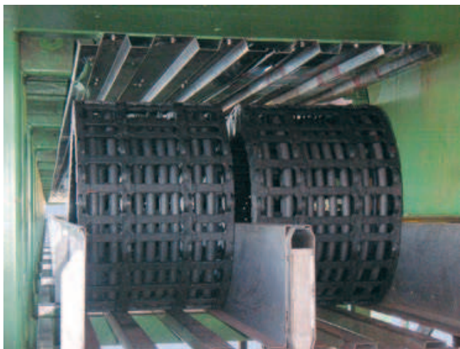
igus® System E4 mit Mittellasche an einem Schiffsentlader für die Kohleentladung. Verfahrweg 105 m, Geschwindigkeit 240 m/min, Zusatzlast 53 kg/m
